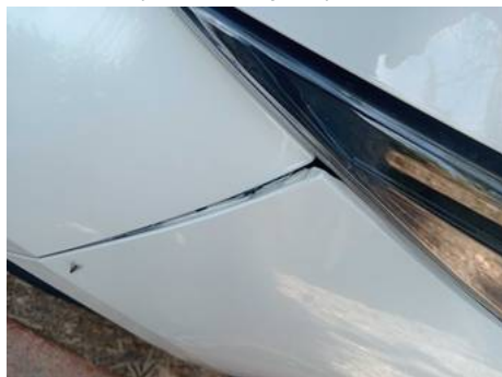
Bouclier avant (Défaut aspect)
